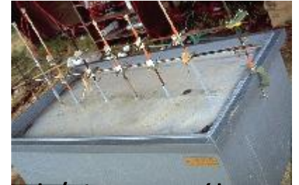
Tank/citernes électrolyse (acide sulfurique pH 0.05)
